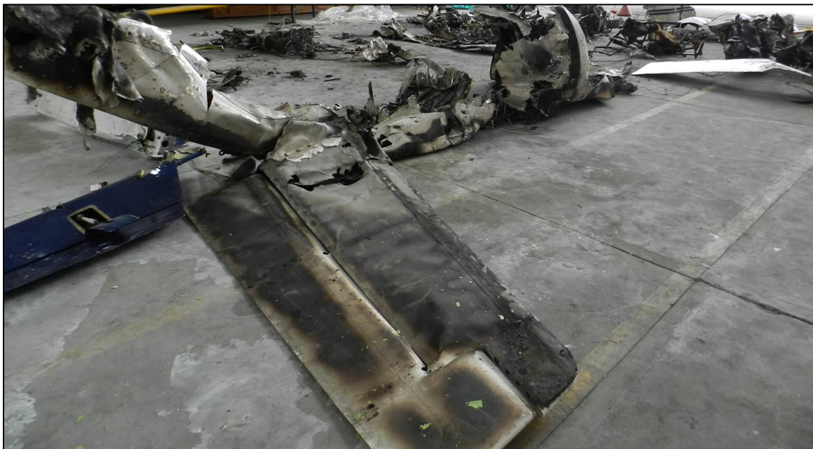
Estabilizador y elevador horizontal derecho
