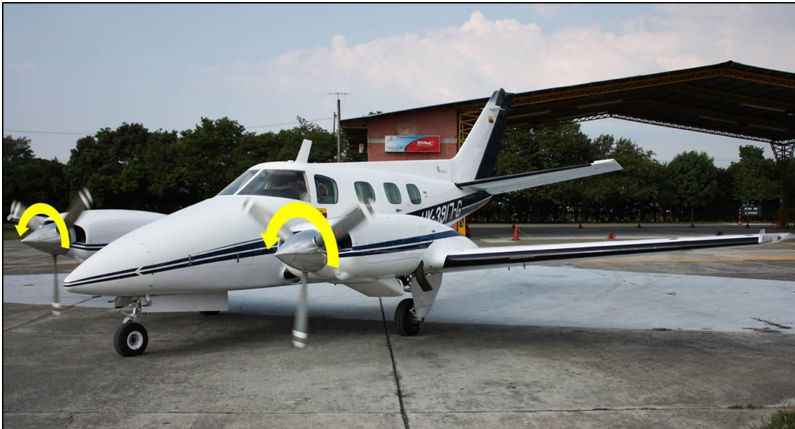
Sentido de rotación de las hélices en la aeronave Beechcraft BE-60 HK3917G
