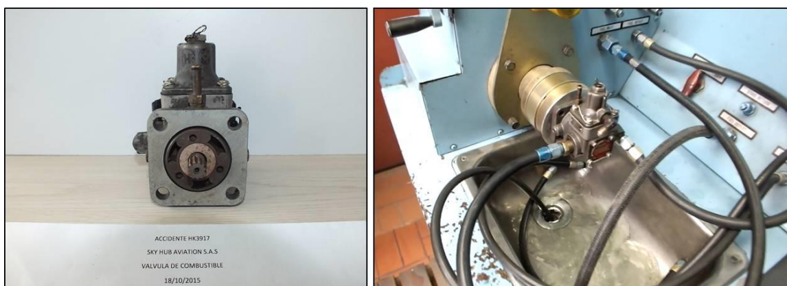
Válvula de combustible del motor izquierdo en inspección y ensayos de funcionamiento
